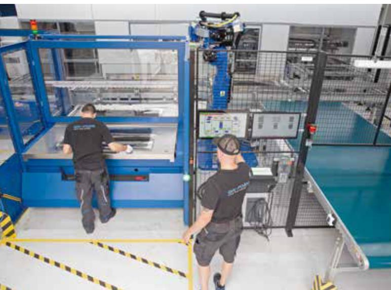
Am Ende des Prozesses werden die geformten Inserts mit dem Schlitten aus der Anlage ausgeschleust und vom Roboter an der Entnahmestelle abgelegt.
