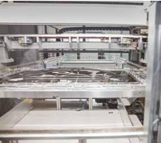
Wenige Schritte neben der Anlage findet die End-of-line-Prüfung statt. Kameras unterziehen jedes einzelne Bauteil einer Qualitätskontrolle.
