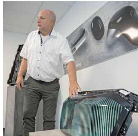
Das Frontpanel eines Elektrofahrzeugs lässt sich mit den siebbedruckten Inserts individuell gestalten. Beim Spritzgieß-Partner RESRG wird das Insert mit einer 3-mm-PC-Schicht vorgespitzt, und im nächsten Schritt wird der Halterand hinterspritzt.
